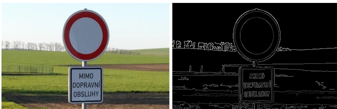
Obrázek 2.5: Detekce hran pomocí Cannyho hranového detektoru. Upraveno pomocí OpenCV.
