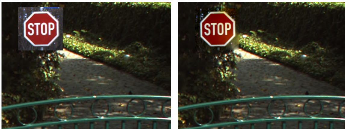
Obrázek 5.3: Porovnání vložení ořezané dopravní značky do pozadí bez použití ( vlevo ) a s použitím ( vpravo ) techniky Poisson blending .
