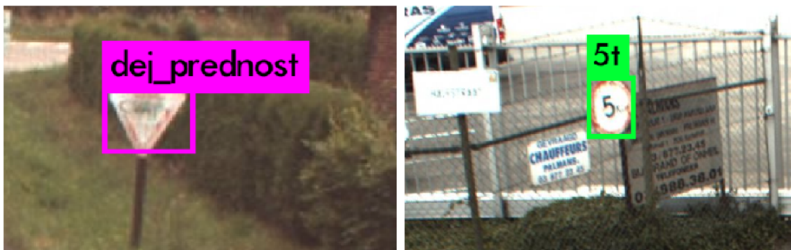
Obrázek 6.8: Správné detekce i přes nízkou kvalitu či poškození dopravních značek.
