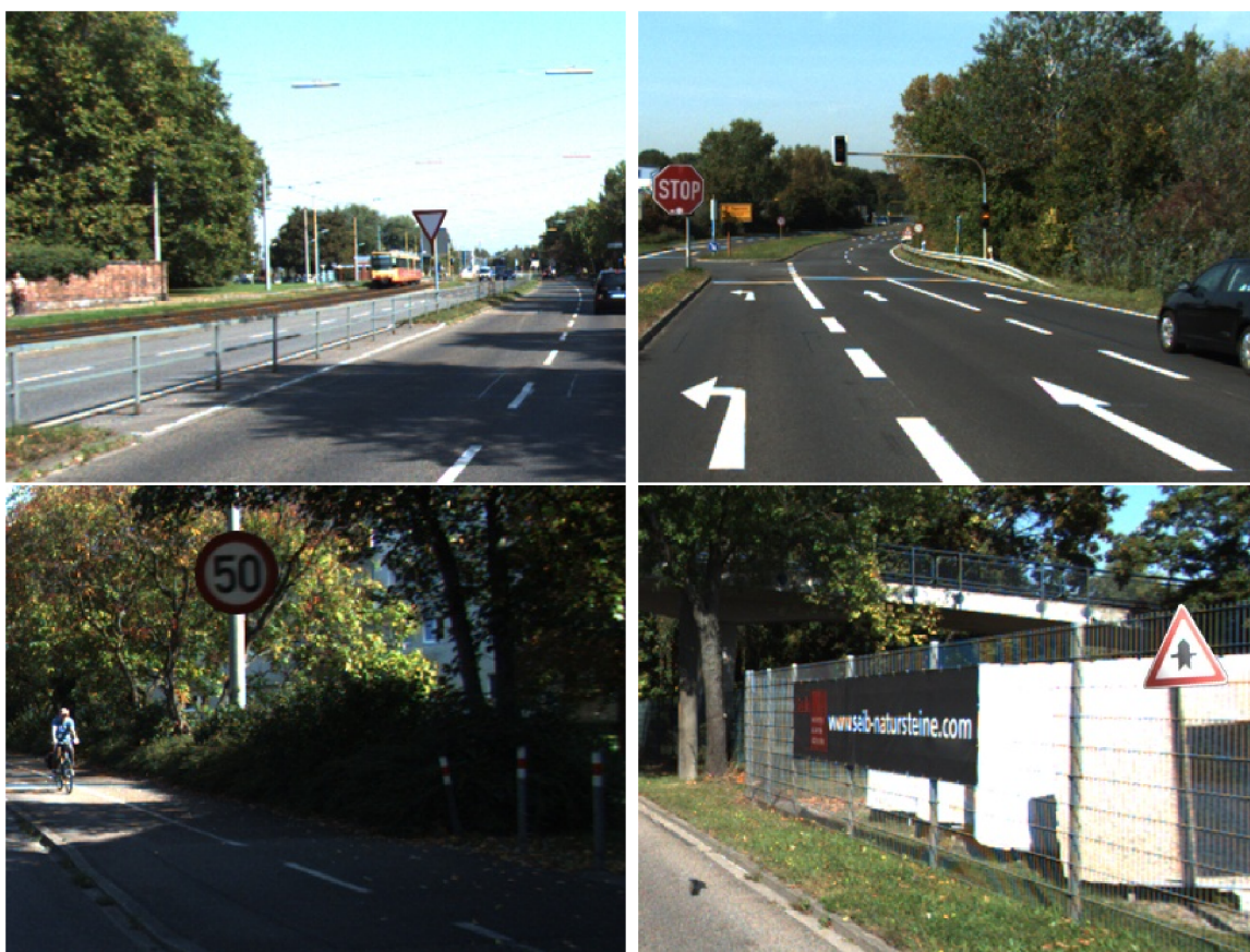
Obrázek 5.1: Příklad vygenerovaných dat za pomoci transparentních značek. Značkám bylo před vložením do snímku pozadí upraveno osvětlení, velikost a natočení.
