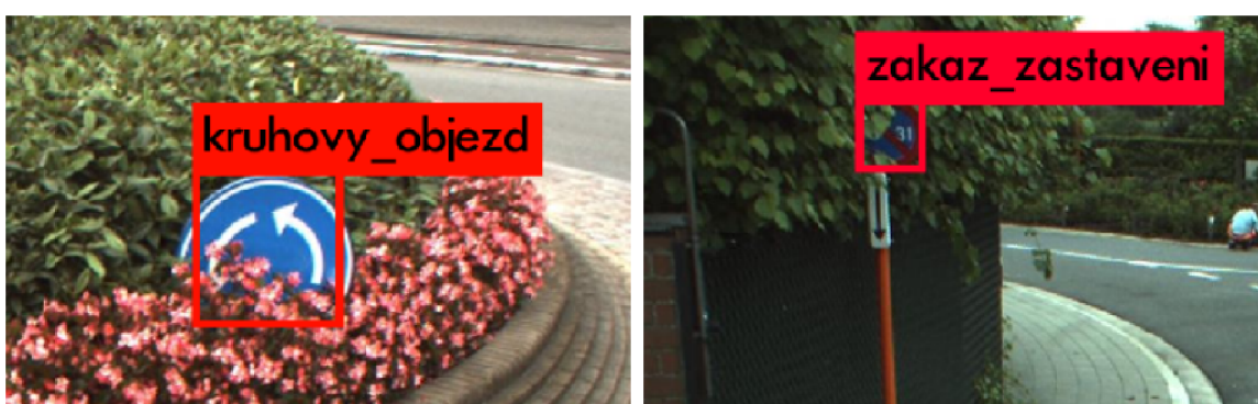
Obrázek 6.6: Správné detekce i při částečném překrytí.
