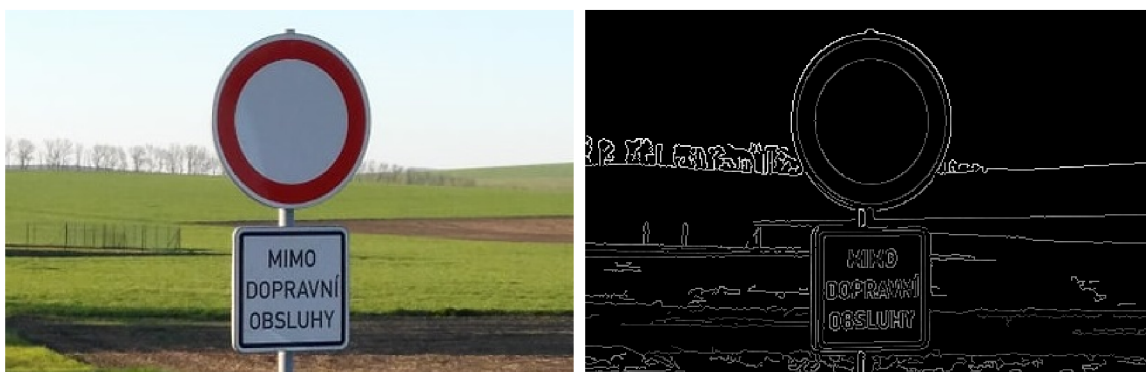
Obrázek 2.5: Detekce hran pomocí Cannyho hranového detektoru. Upraveno pomocí OpenCV.
