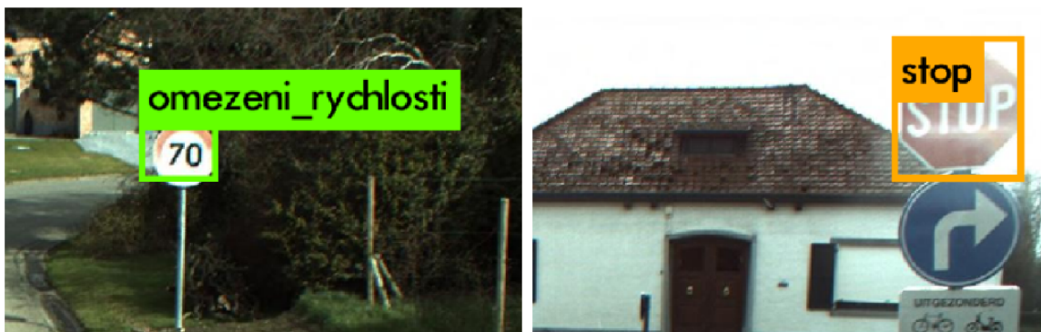
Obrázek 6.5: Správné detekce i za zhoršených světelných podmínek.
