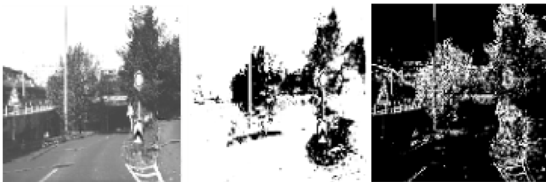
Obrázek 5.4: Vizualizace třech filtrů z jedné z konvolučních vrstev modelu.
