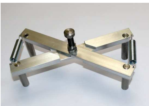
Obr. 3-11: Špeciálne nožnice s jamkovačom [32]
