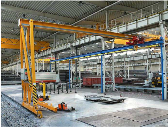
Obr. 3-7: Príklad poloportálového žeriava [29]
