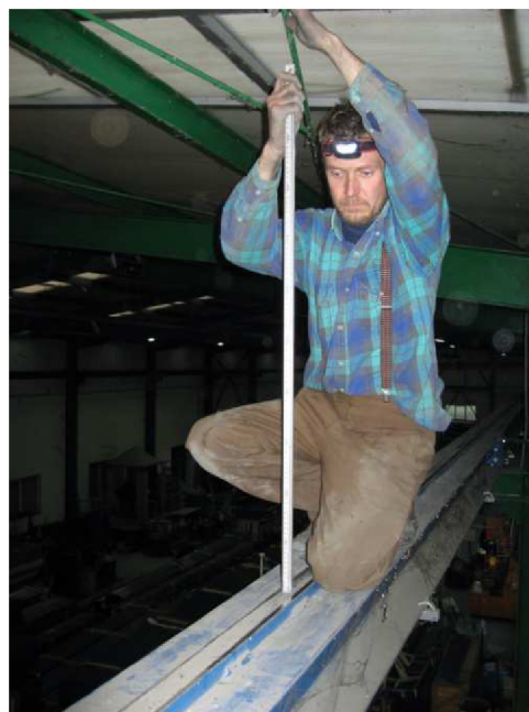
Obr. 5-10: Ukážka merania výškových odchýlok
