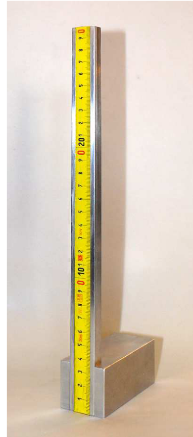
Obr. 3-10: Pravítko pre meranie výškových odchýlok [34]
