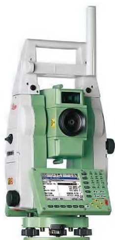
Obr. 4-1: Totálna stanica Leica z radu TPS1200+ [36]
