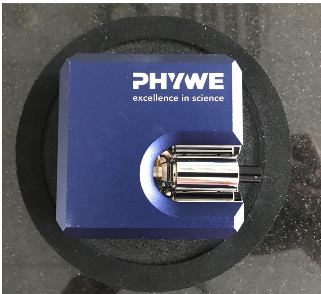
Obr. 24: Hlavní řídicí jednotka s namontovanou snímací hlavou. Ve výřezu je umístěn držák se vzorkem, ke kterému směřuje hrot (Foto: autorka).
