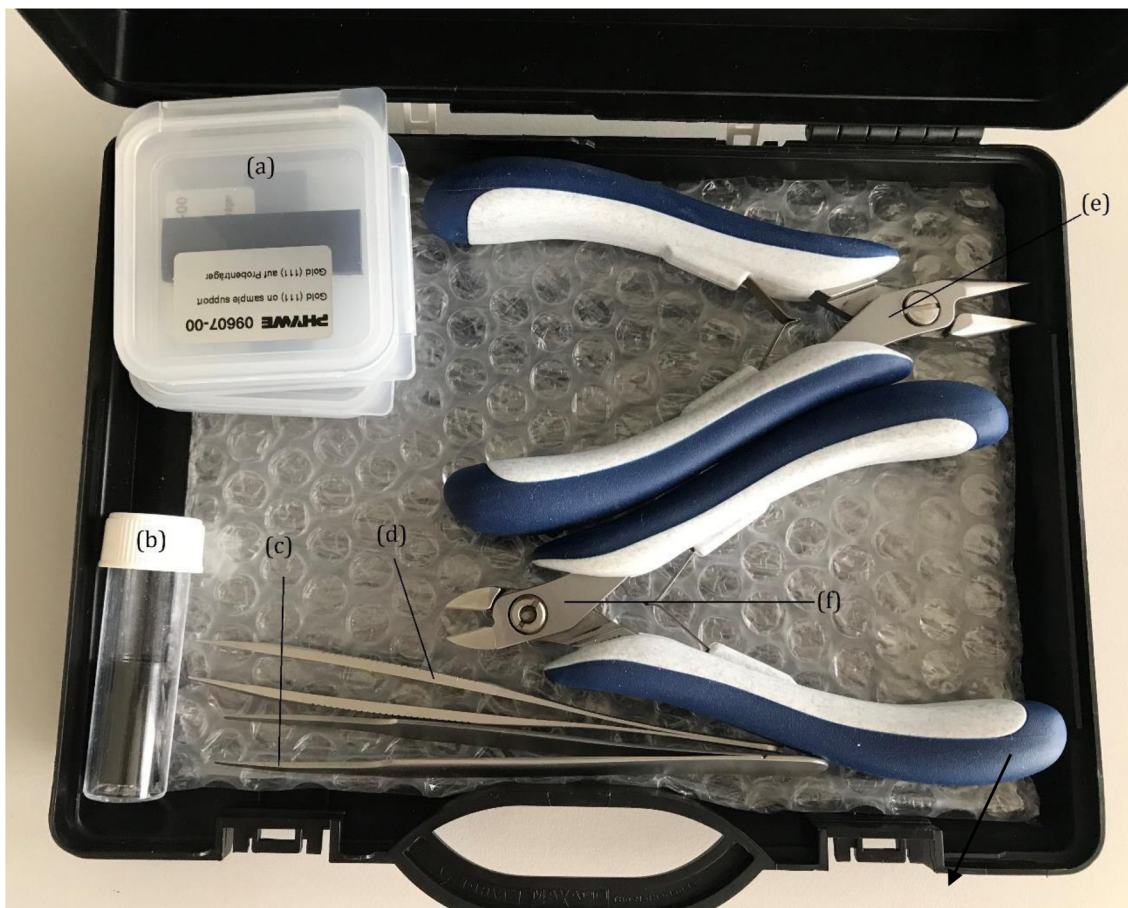
Obr. 27: Kufrík s náradím a vzorky. (a) Krabičky se vzorky povrchů pevných látek (zlato, grafit), (b) držák vzorků, (c) zaoblená pinzeta, (d) špičatá pinzeta, (e) ploché kleště, (f) štípací kleště (Foto: autorka).
