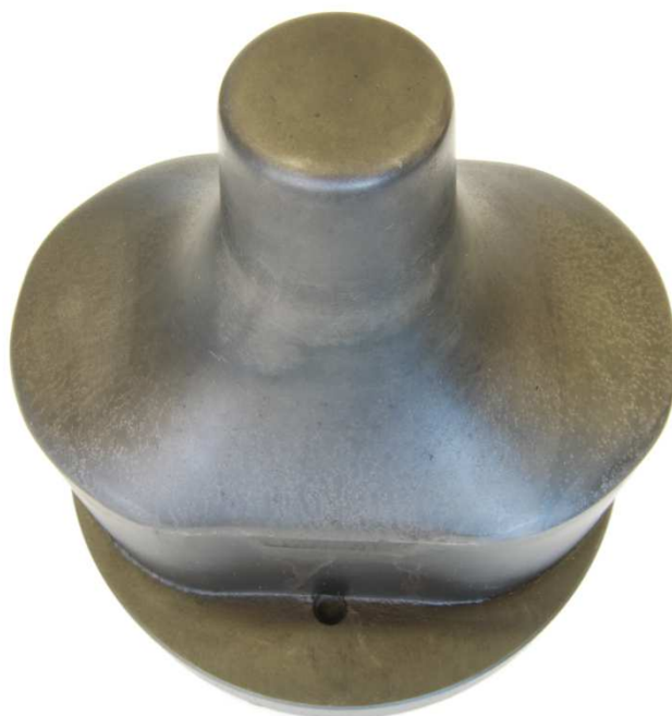
Obr. P1.1 Poškozená sklářská forma
