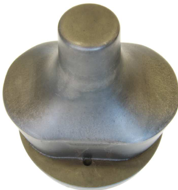
Obr. P1.1 Poškozená sklářská forma
