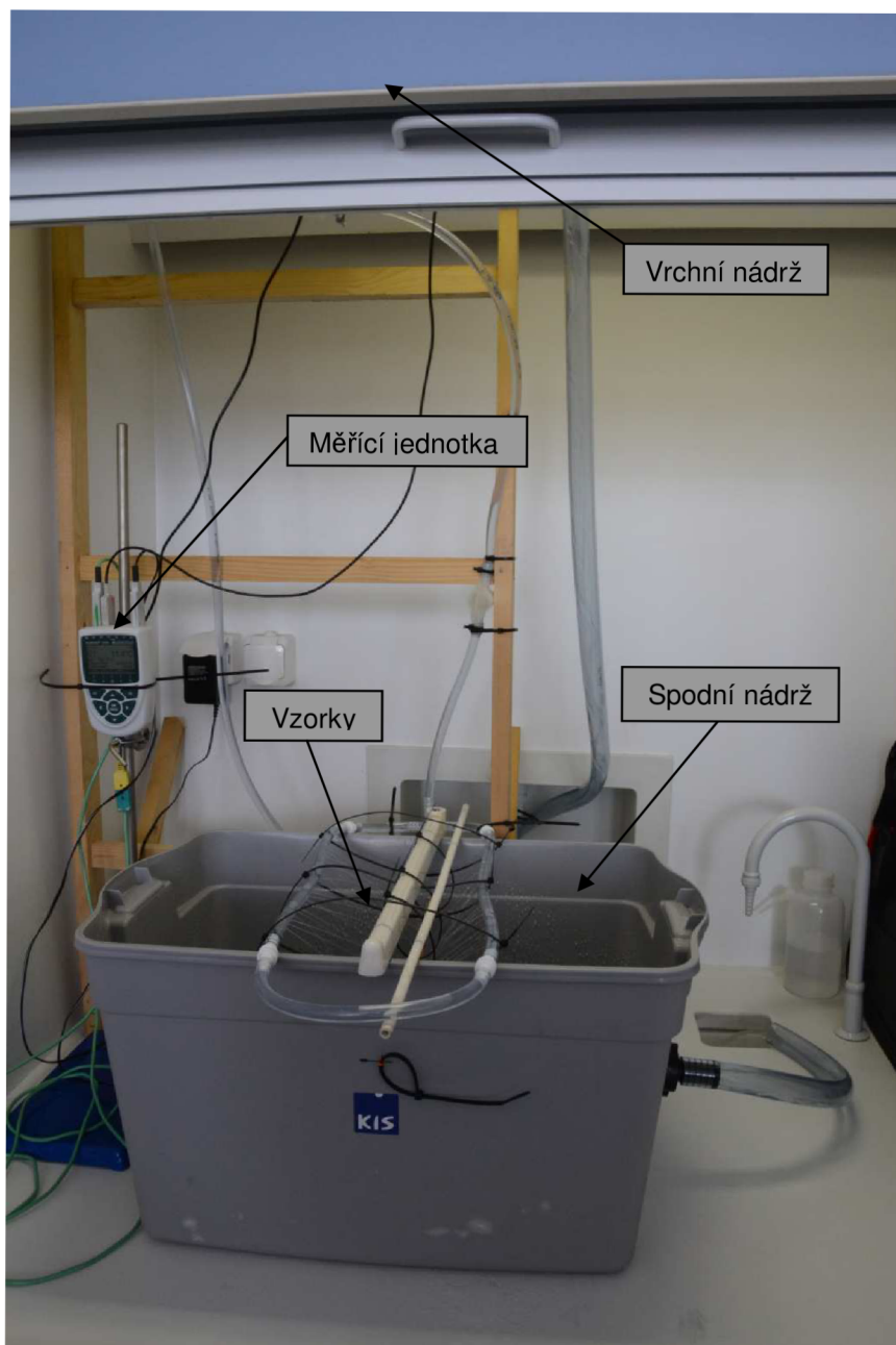
Obr. P1.3 Korozní zkouška pod sprchou
