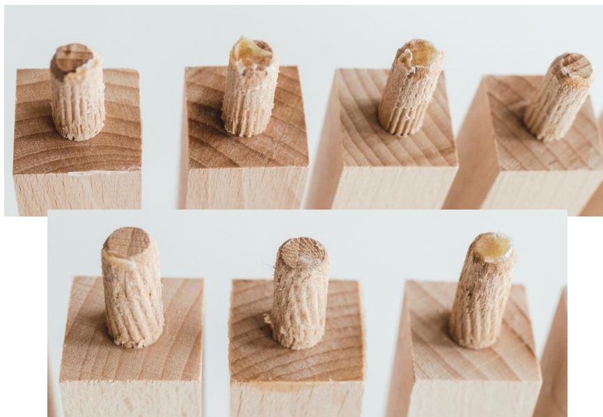
Obrázek 16: Rovně a spirálovitě rýhované kolíky po zkoušce tahem
