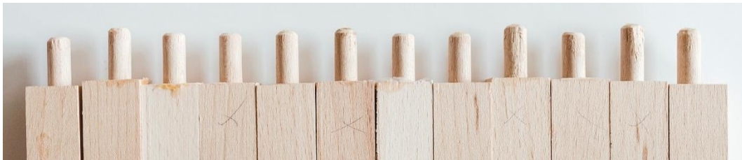
Obrázek 18: Kolíky po vykonání tahové zkoušky
