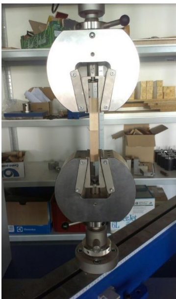
Obrázek 13: Uchycení zkušebního tělesa v čelistech trhacího stroje
