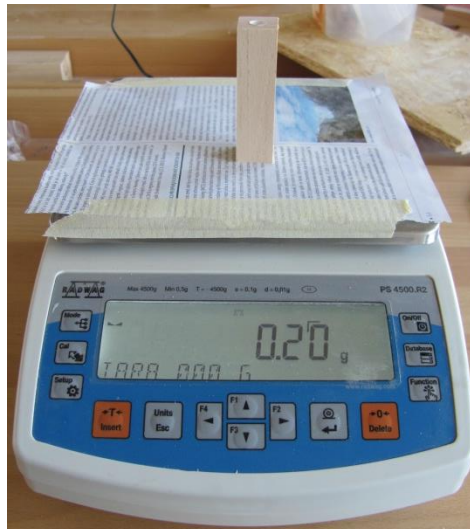
Obrázek 8: Nanášení lepidla do předvrtaného otvoru a vážení
