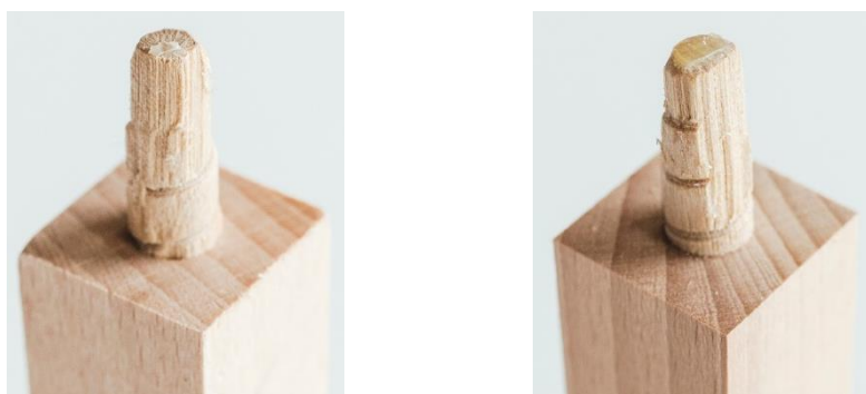
Obrázek 15: Kolík s hlubokou spirálou po zkoušce tahem
