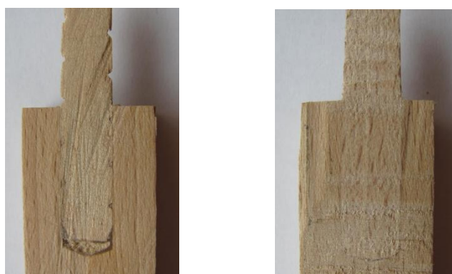
Obrázek 17: Řez testovací sestavou - rozdíl mezi vyvedením a stlačením lepidla v otvoru pro kolík
