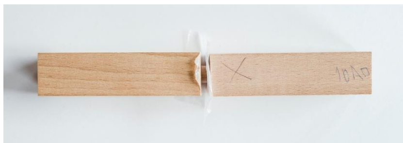
Obrázek 14: Roztržený vzorek po vykonání tahové zkoušky
