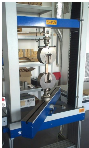
Obrázek 5: Univerzální trhací stroj – TIRA TT 2850 – uchycení zkušební vzorku
