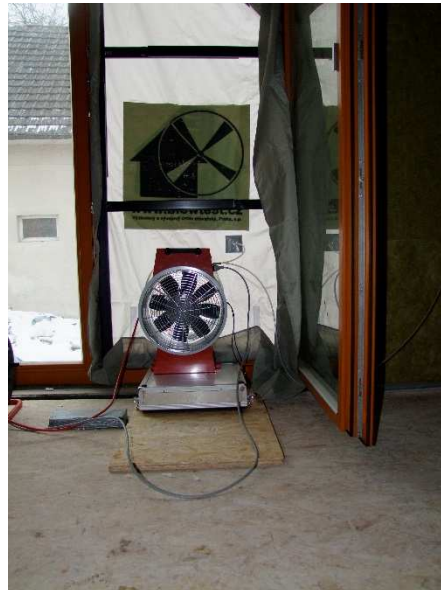
Obrázek 38 Umístění měřícího zařízení se vzduchotěsnou plachtou.
