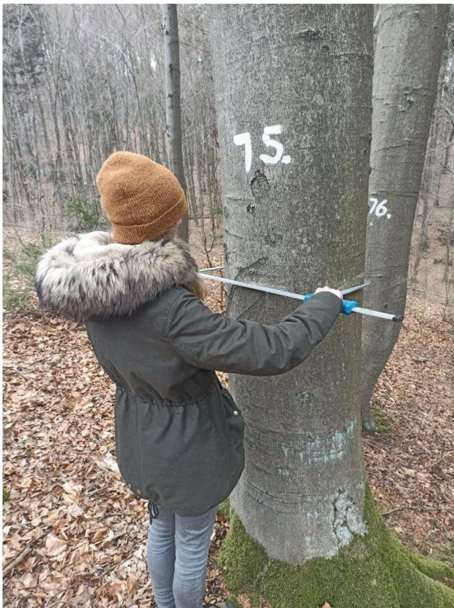
Příloha č.12. Měření tloušťky (obnověných) vyznačených stromů pomocí digitální průměrky na zkusné ploše.
