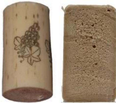
Obrázek 12 - Zátka z termoplastického elastomeru vyrobená pomocí nadouvadel (Běhálek, 2016)
