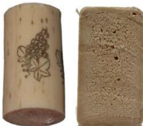
Obrázek 12 - Zátka z termoplastického elastomeru vyrobená pomocí nadouvadla (Běhálek, 2016)
