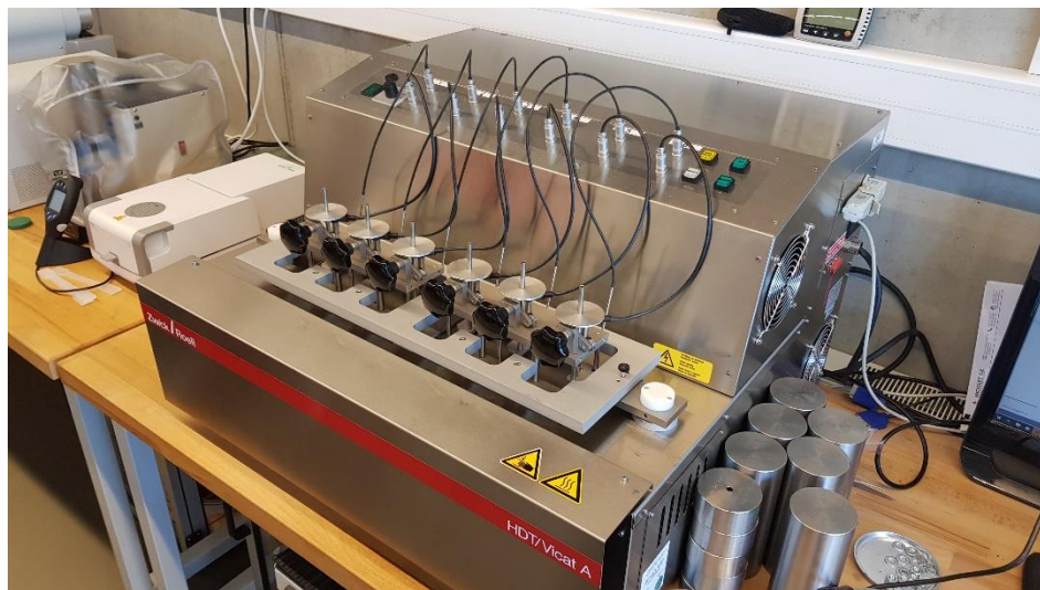
Obr. 3.11 Měřicí zařízení HDT/Vicat A se vzorky ponořenými v temperační lázni
