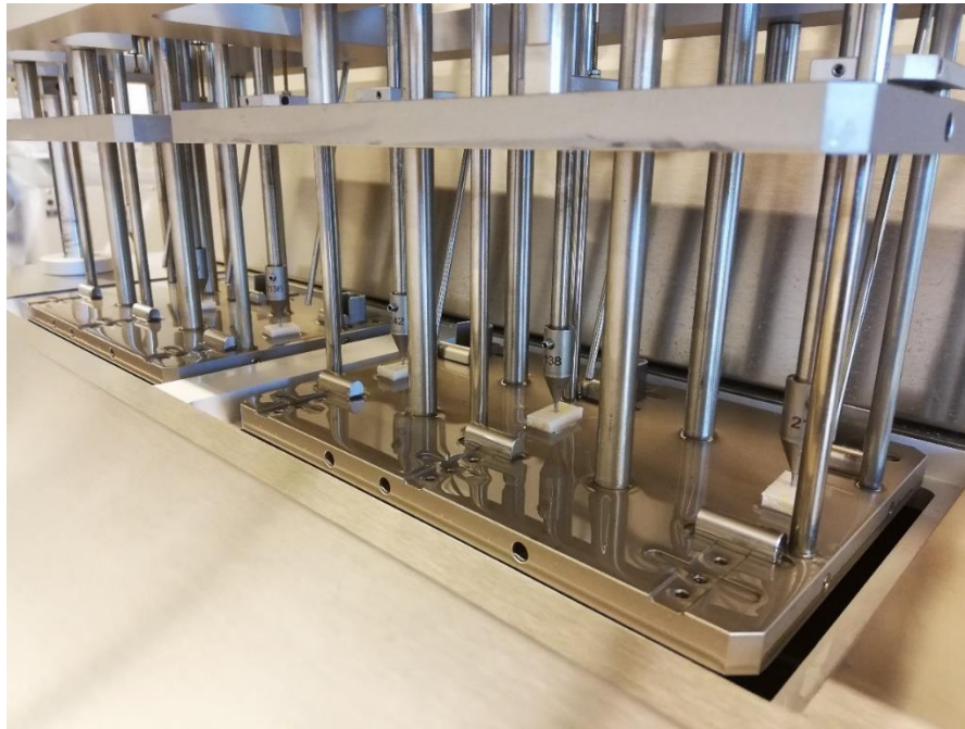
Obr. 3.10 Princip zkoušky měknutí materiálu dle Vicata
