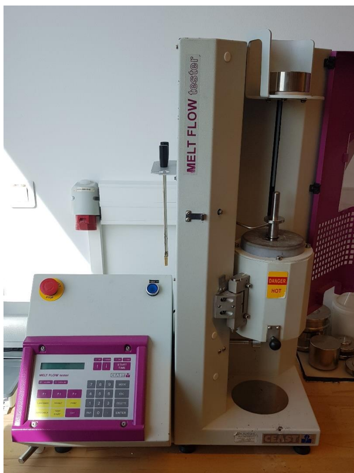
Obr. 3.2 Kapilární výtlačný plastometr Melt flow tester
