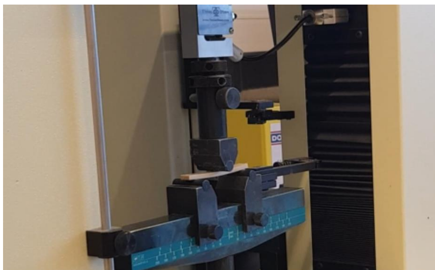
Obr. 3.8 Ohybové zatěžování zkušebního vzorku
