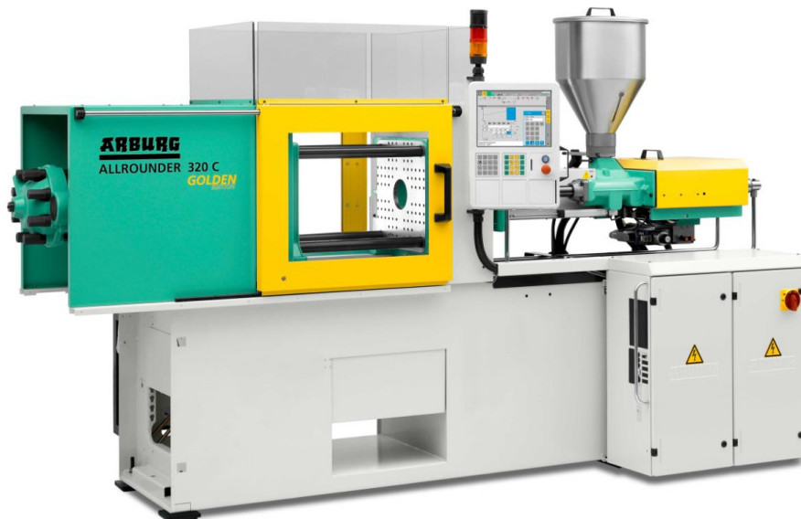
Obr. 3.1 Hydraulický vstřikovací stroj ARBURG Allrounder 320 C Golden Edition [25]
