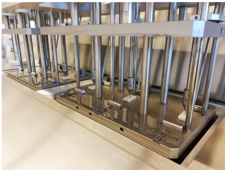
Obr. 3.10 Princip zkoušky měknutí materiálu dle Vicata
