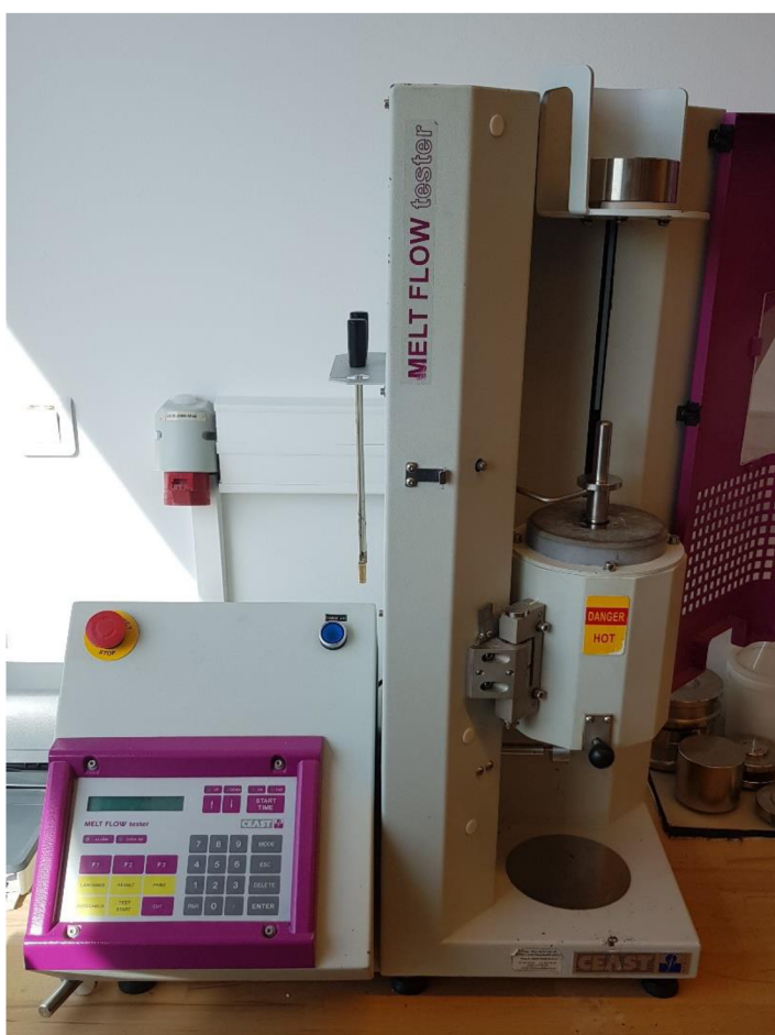
Obr. 3.2 Kapilární výtlačný plastometr Melt flow tester
