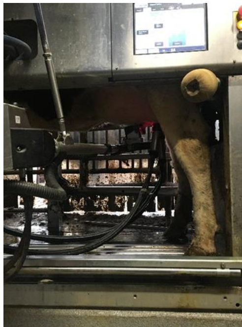
Obr. 16 Robotické rameno identifikuje struk vemene
