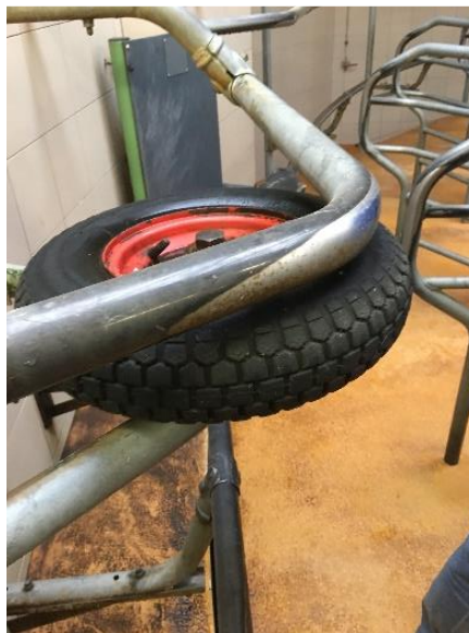
obr. 5 Kolo pomáhající ke správnému otáčení krav do dojícího boxu
