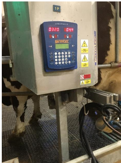
obr. 14 Informační panel jednoho dojícího stání
