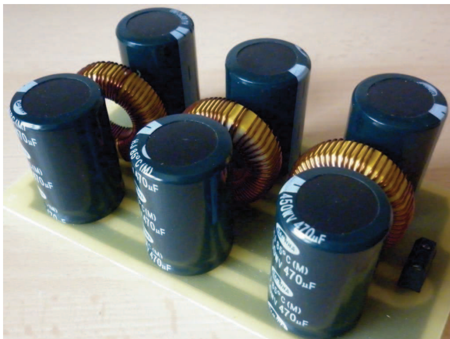
Obr. 5.6: Osazená deska banky kondenzátorů
