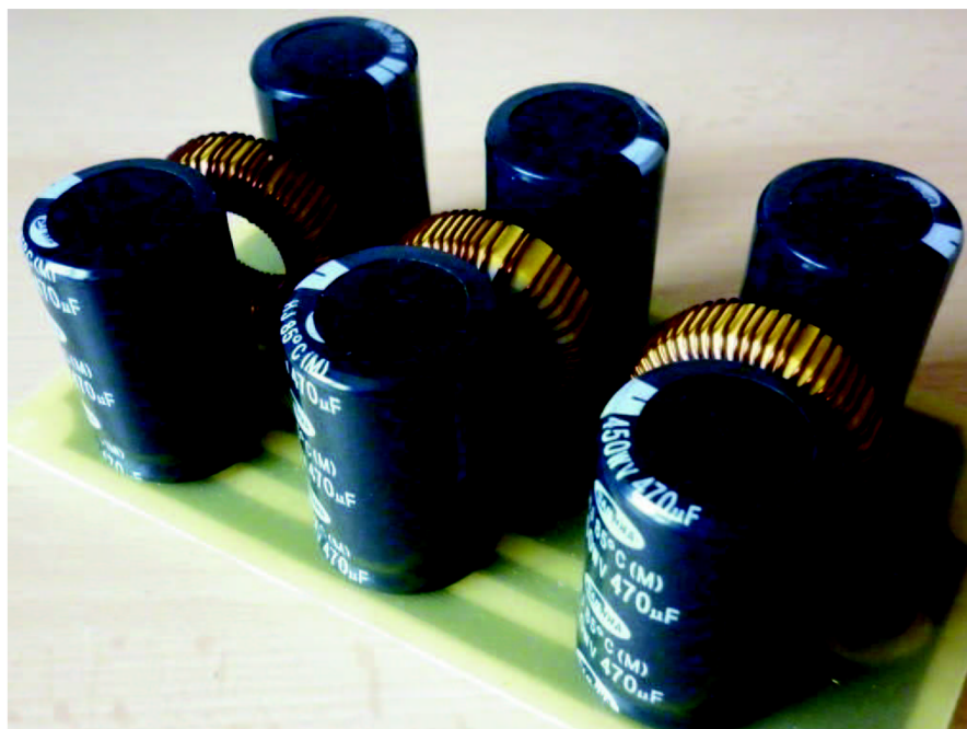
Obr. 5.6: Osazená deska banky kondenzátorů
