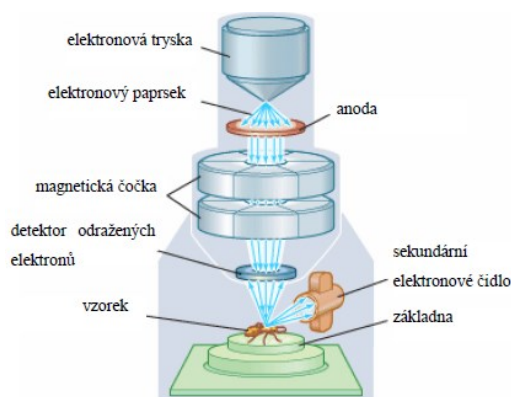
Obr. 18: Schéma SEM snímače (www.fzu.cz, 2019).
