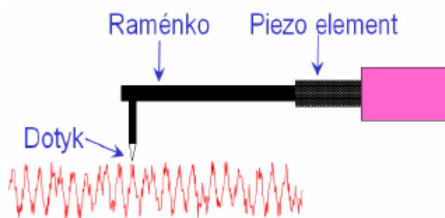
Obr. 19: Schéma piezoelektrického snímače (Svatoš, 2009)
