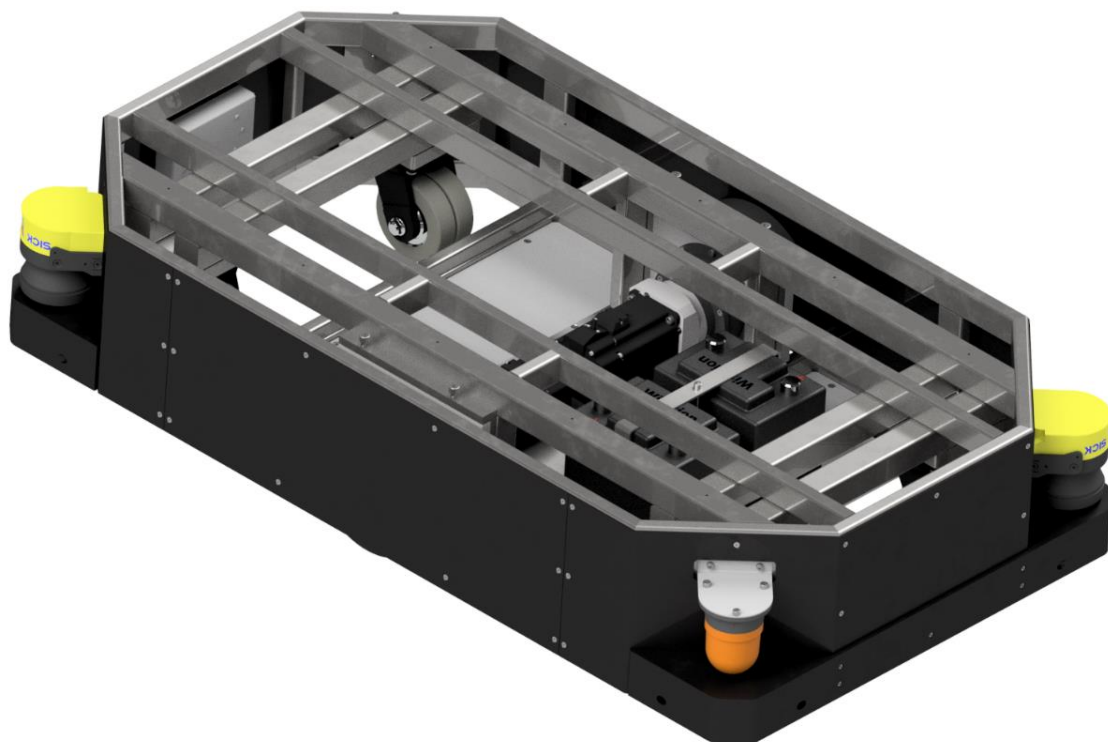
Obr. 65 Koncept zakrytování konstrukce_2
