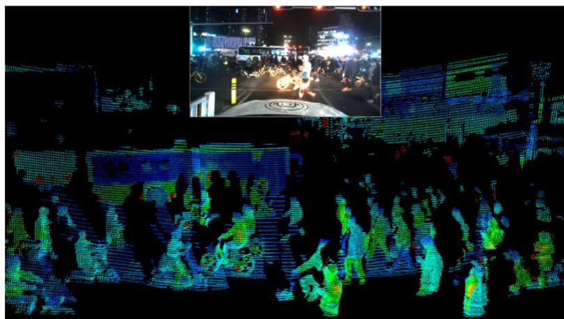
Obr. 29 Obraz snímáný LiDAR senzorem [47]
