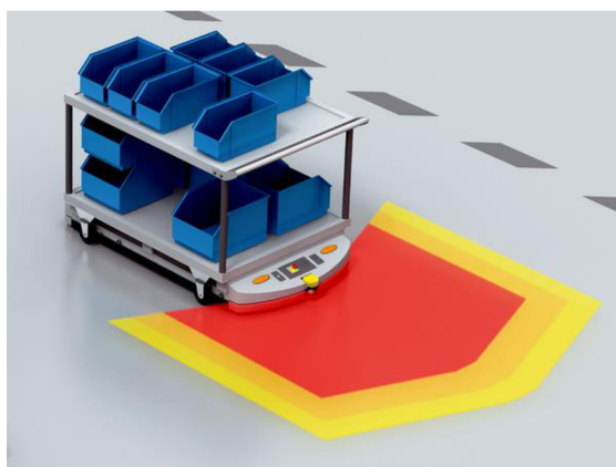
Obr. 32 Skenovaná bezpečnostní oblast [49]
