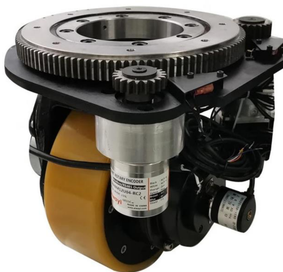
Obr. 10 Natáčecí AGV kolo [41]
