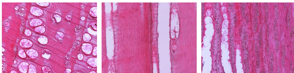
Obrázek 8 Mikroskopická stavba akátu 40x zvětšeno (zleva příčný řez, radiální řez a tangenciální řez)
