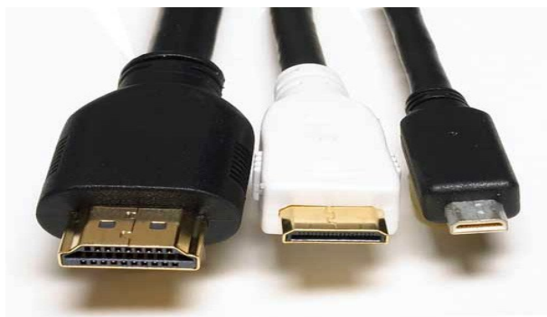
Obrázek 4.7 konektory HDMI zleva typ A,C,D
