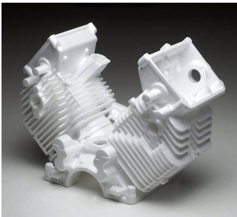
Obr. 24 Model zhotovený technologií lost foam [19]
