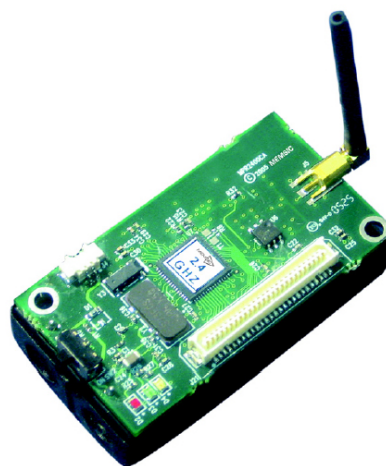
Obr.4: Hardwarová realizace uzlu MicaZ [5].
