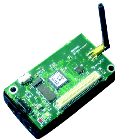
Obr.4: Hardwarová realizace uzlu MicaZ [5].
