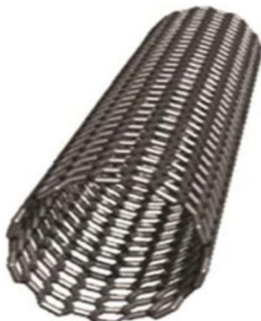
Obrázek 2.8 Krystalografická struktura uhlíkové jednotěné nanotrubičky [38]
