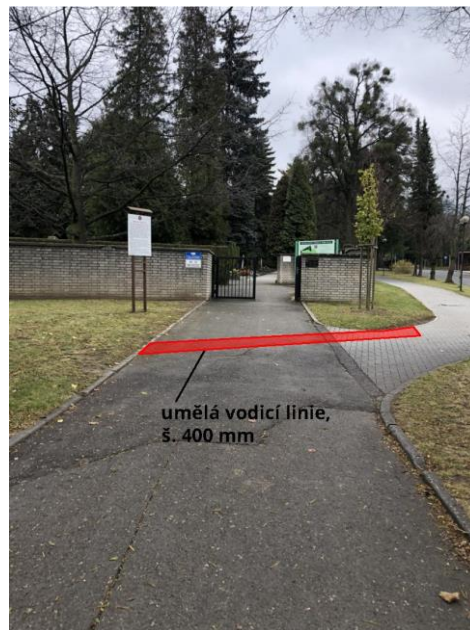
Obrázek 78: Umělá vodící linie
