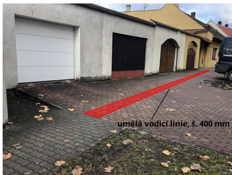
Obrázek 207: Umělá vodící linie
