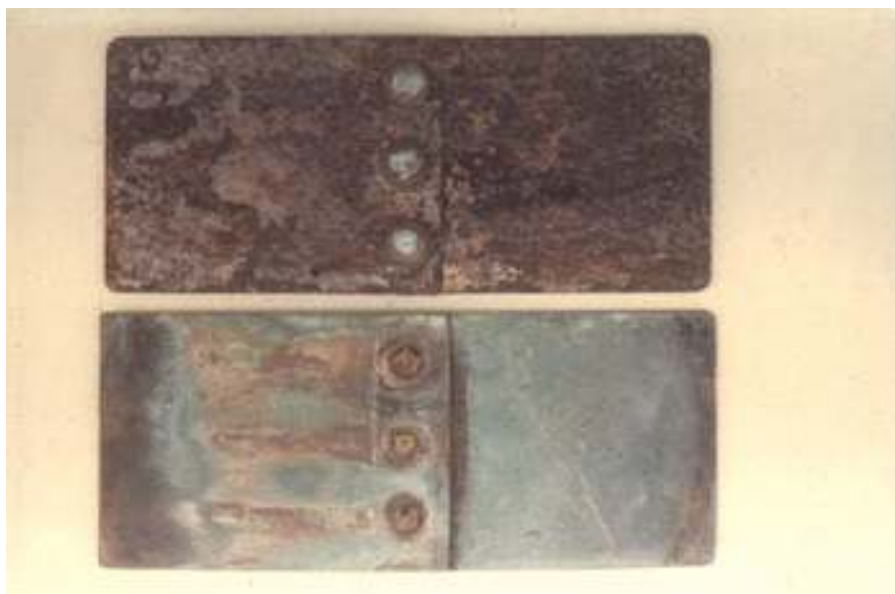
Obrázek 3: Galvanický článek měď - železo. Vliv poměru ploch (nahore malá katoda - velká anoda, dole velká katoda - malá anoda) [7].
