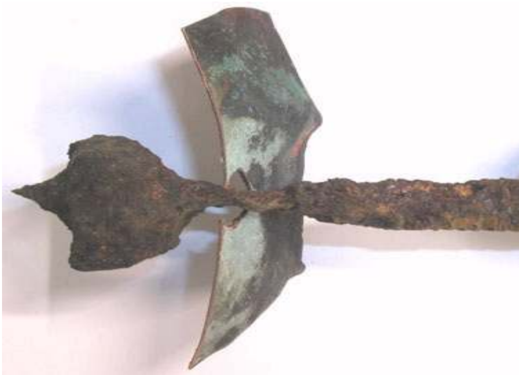
Obrázek 1: Urychlení koroze železného šroubu v místě průchodu měděným pláštěm [7].
