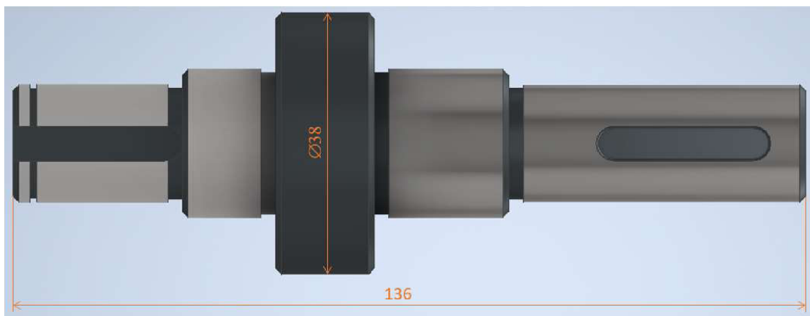
Obr. 3 Vyráběná hřídel se znázorněním hlavních rozměrů.
