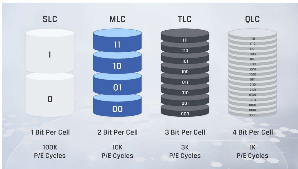
Obrázek 8 - Typy paměťových NAND hradel (16).
