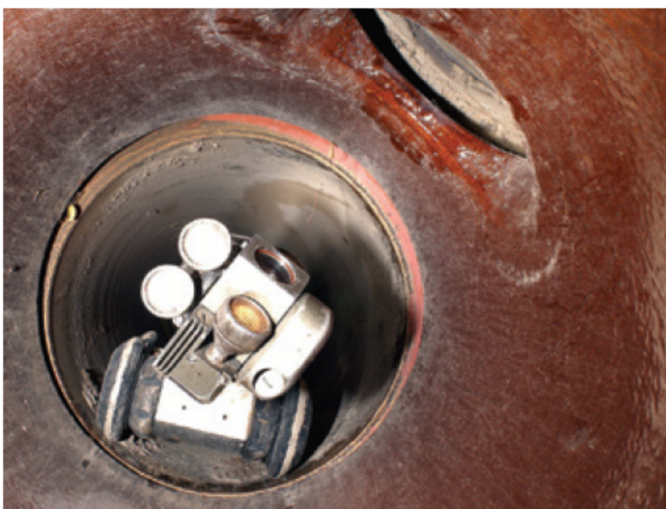
Obrázek 11 – Vizuální průzkum stoky pomocí robota s kamerami (PVK, 2016)
