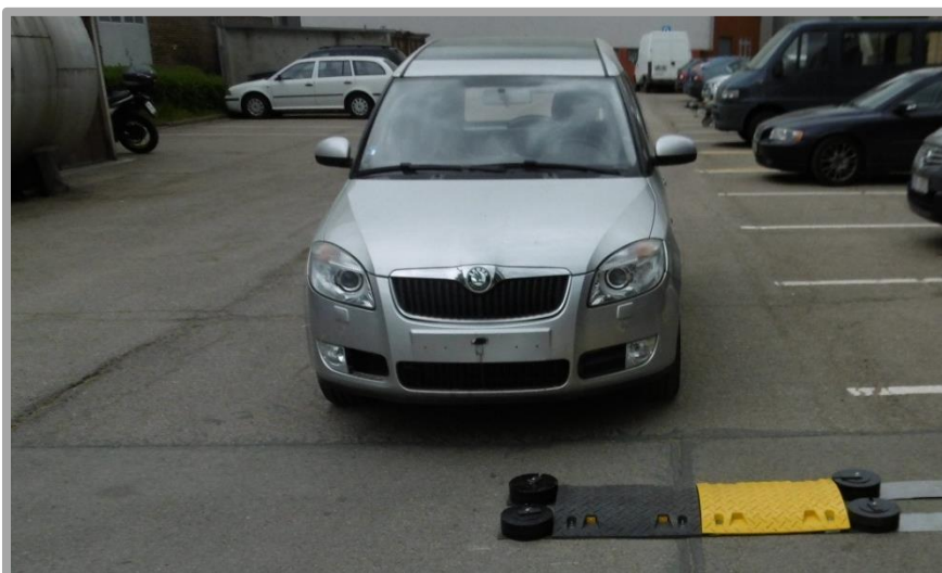
Obr. 5.32 Přejezd prahu každým kolem zvlášť
