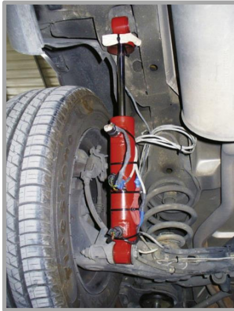
Obr. 2.27 Měřicí zařízení na tlumiči [26]
