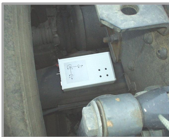
Obr. 2.16 Akcelerometr instalovaný na tuhé zadní nápravě (Scania 124 L3) [20]
