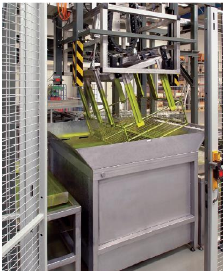
Obr. 6.3.1 Design ponorného koše pro hromadné zkoušení v automatické kapilární lince [23]
