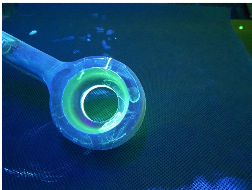
Obr. 5.3.1 Indikace po 10 minutách penetrace Ardroxu 9721 a 6 minutách vyvíjení [Fotoarchiv ATG s.r.o.]
