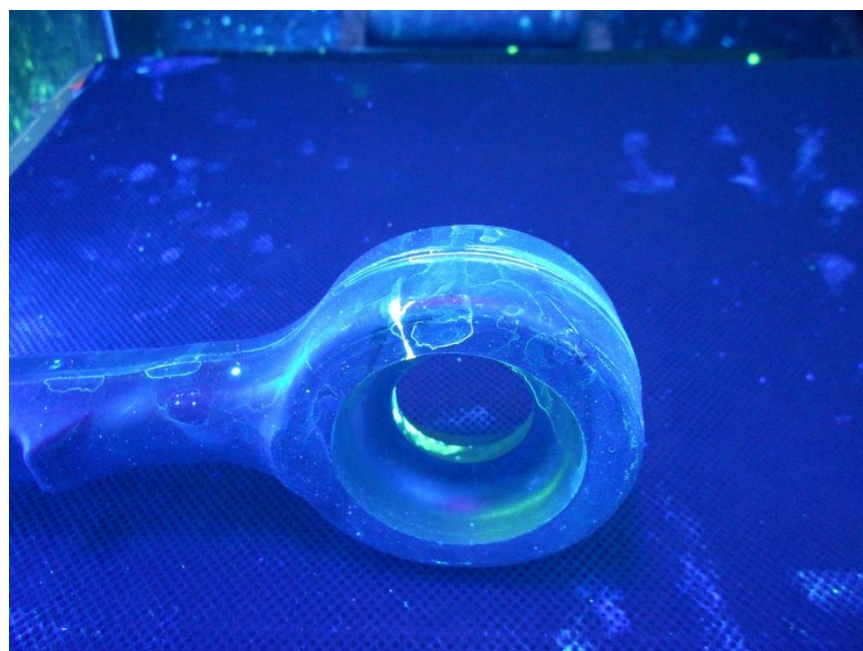
Obr. 5.3.2 Indikace po 6 minutách penetrace Ardroxu 9721 a 6 minutách vyvíjení [Fotoarchiv ATG s.r.o.]
