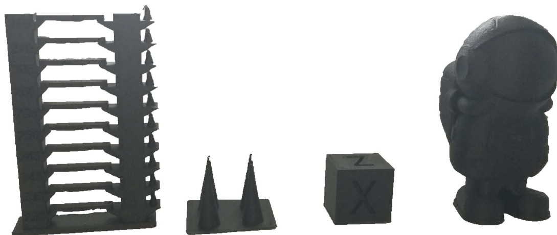
Obr. 5-3) Modely ve finální iteraci vývoje tiskových profilů pro materiál PET-G CF Jet
