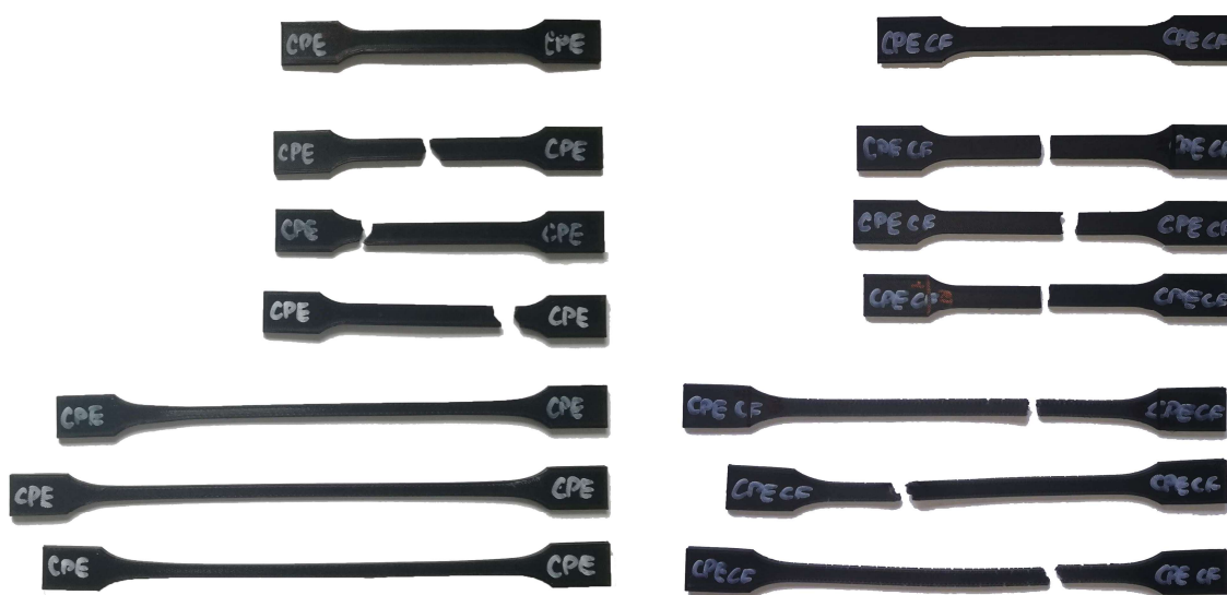
Obr. 5-13) Porovnání všech vzorků se základem CPE z tahové zkoušky CPE HG100 (vlevo), CPE CF112 (vpravo)
