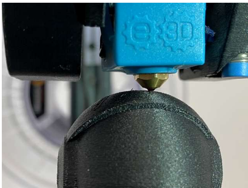
Obr. 5-7) Detail na průběh tisku s vysokou kvalitou povrchů materiálu Nylon CF15
