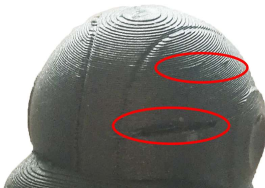
Obr. 5-1) Defekty tvořené ucpáním trysky během tisku
