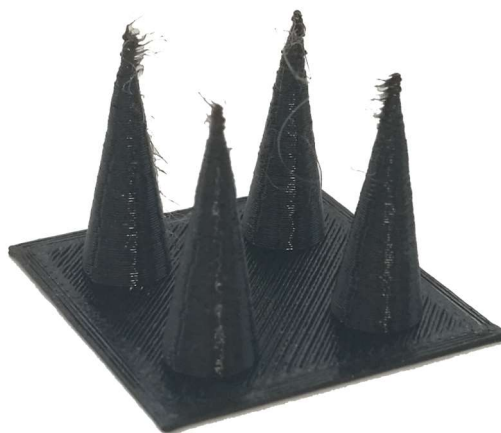
Obr. 5-4) Nežádoucí tvorba vláken polymeru při testu retrakcí
