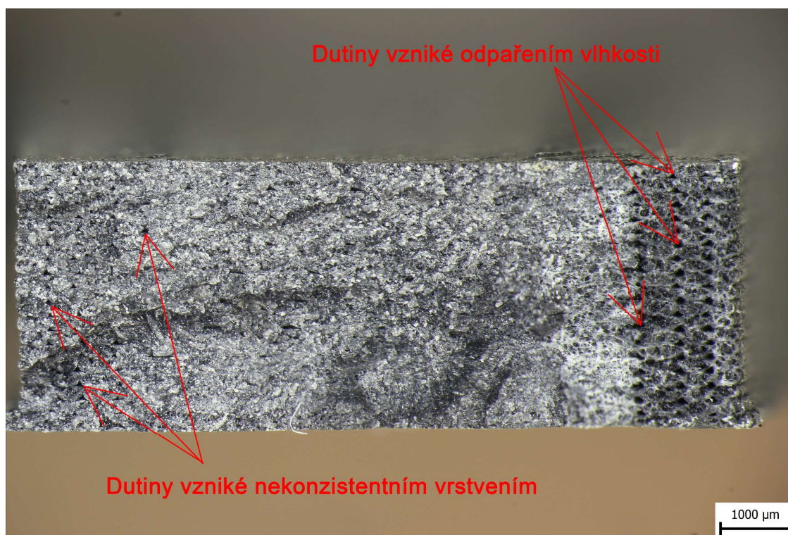
Obr. 5-8) Detail struktury lomu materiálu CPE CF112 s defekty výtisku
