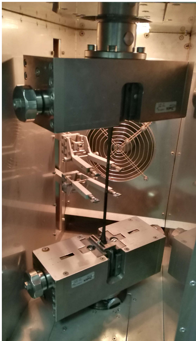
Obr. 5-10) Elastické chování materiálu CPE HG100 za teploty 80 °C
