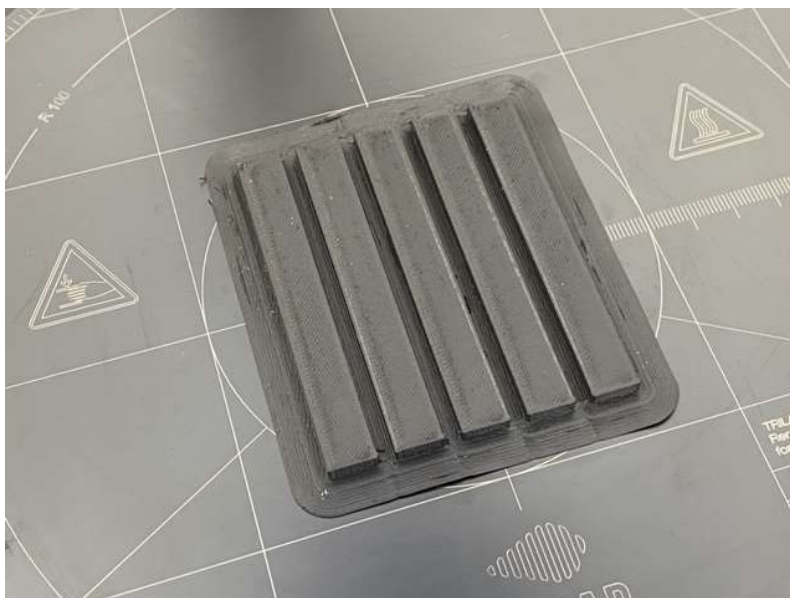
Obr. 4-16) Snímek vytištěných vzorků z materiálu Nylon CF15 za využití funkce Brim
