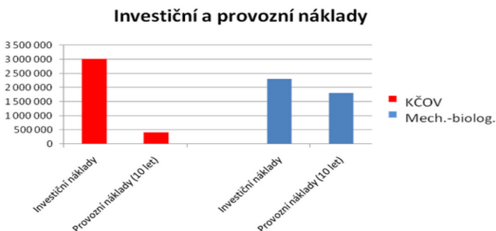
Obrázek 19: Orientační náklady na výstavbu a provoz kořenové čistírny pro 150 ekvivalentních obyvatel (Polák, 2011).
