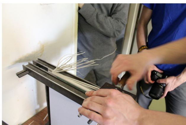
Ořezávání knižního bloku vazby V2
