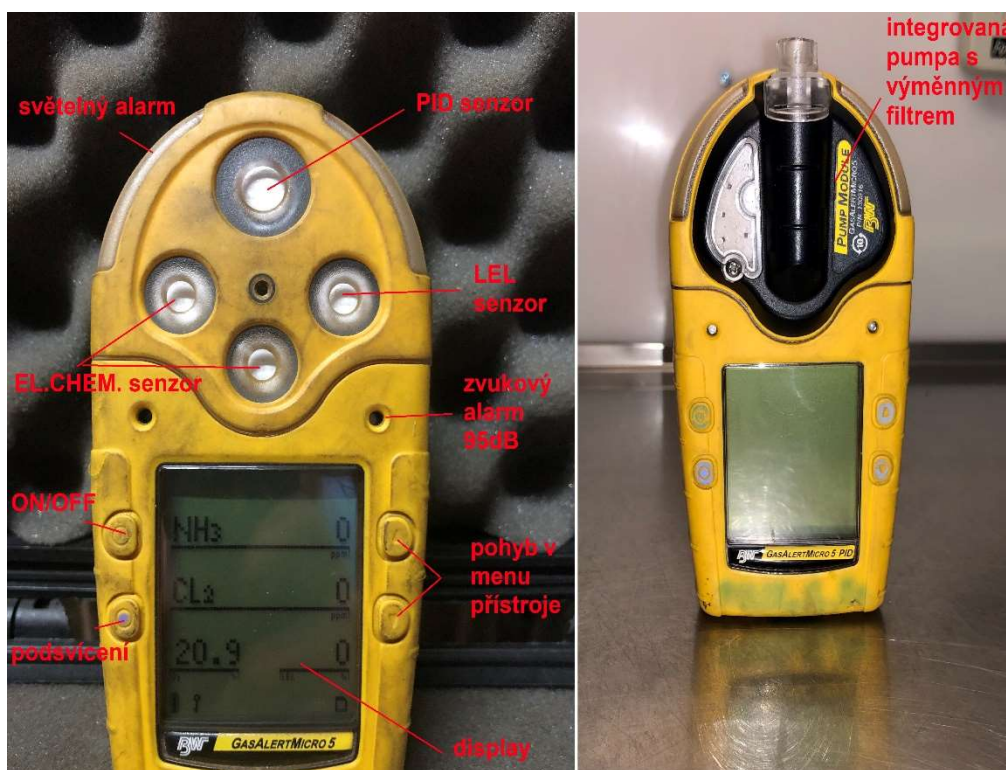
Obrázek 14: Popis detektoru GasAlertMicro5
