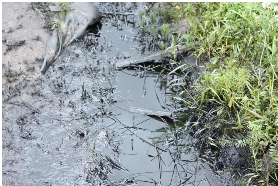
Obrázek 6: Pyrolýzní olej po požáru skládky (Sikora 2017)
