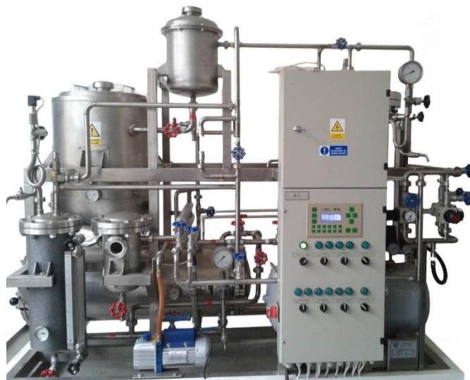
Obr.2 Laboratorní vakuově tlaková linka na úpravu vlastností dřeva typ JHP 1-0072
