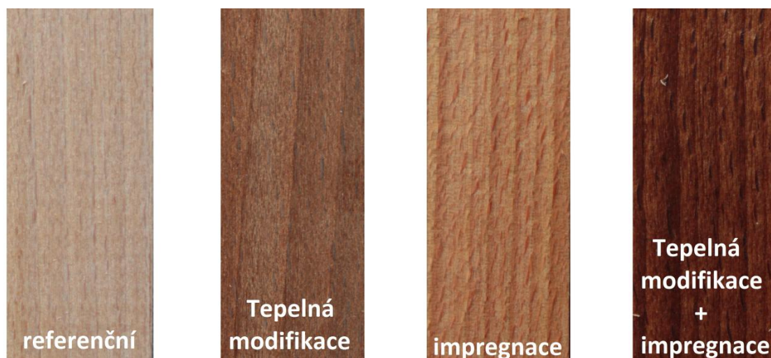
Obr.12 Vizuální porovnání barvy zkušebních vzorků po jednotlivých stupních úpravy.
