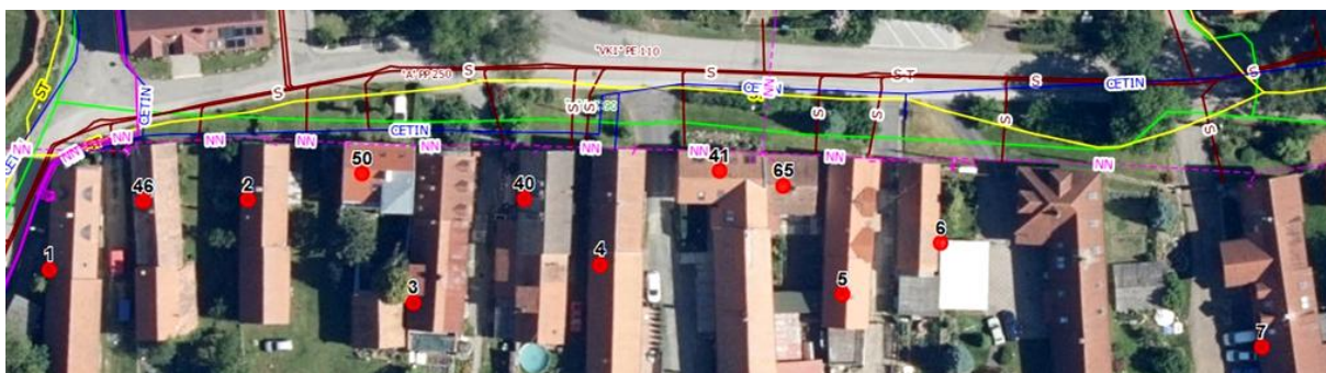
Obr. 66: Inženýrské sítě a přípojky (ružová: elektrina; červená: kanalizace; žlutá: plyn; zelená: voda a modrá: spoje)
