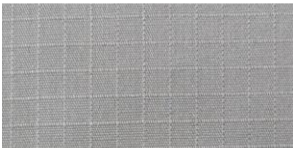
Obrázek 17: Struktura látky ripstop
