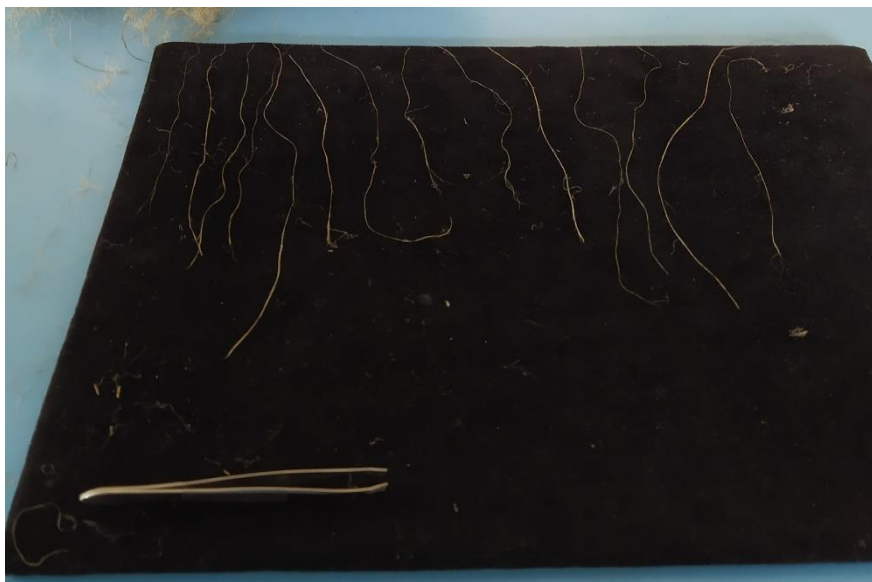
Obr. č. 8: Část vybraných vláken ke zkoušce tahem.
