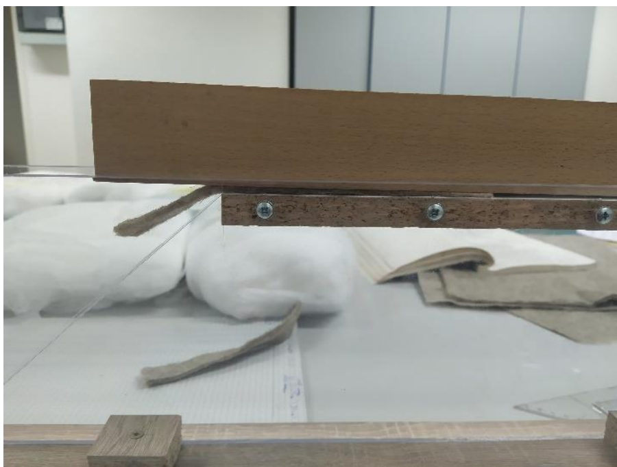
Obr. č. 21: Zkouška tuhosti v ohybu.
