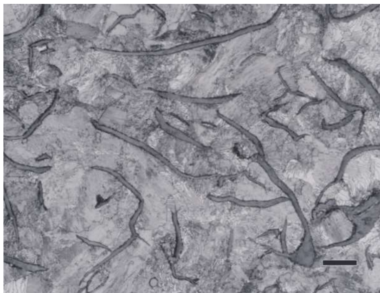
Obr. 20: Litina s lupínkovým grafitem a perlitickou maticí [27].
