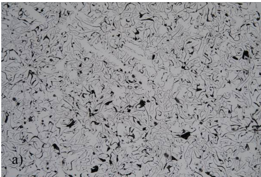
Obr. 35: Metalografický výbrus vzorku s extrémní koncentrací Pb.
