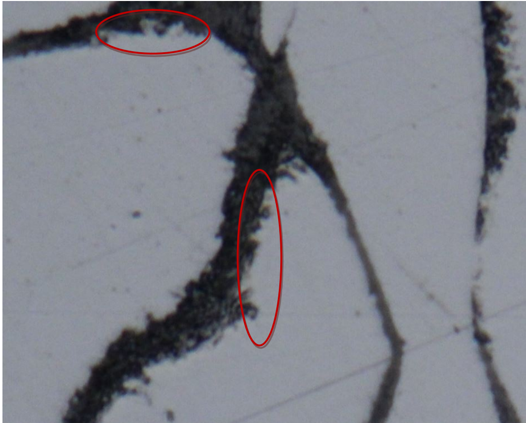
Obr. 36(c) detail: Widmanstättenův grafit.
