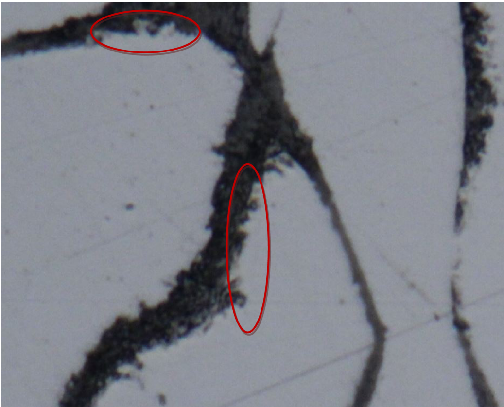
Obr. 36(c) detail: Widmanstättenův grafit.
