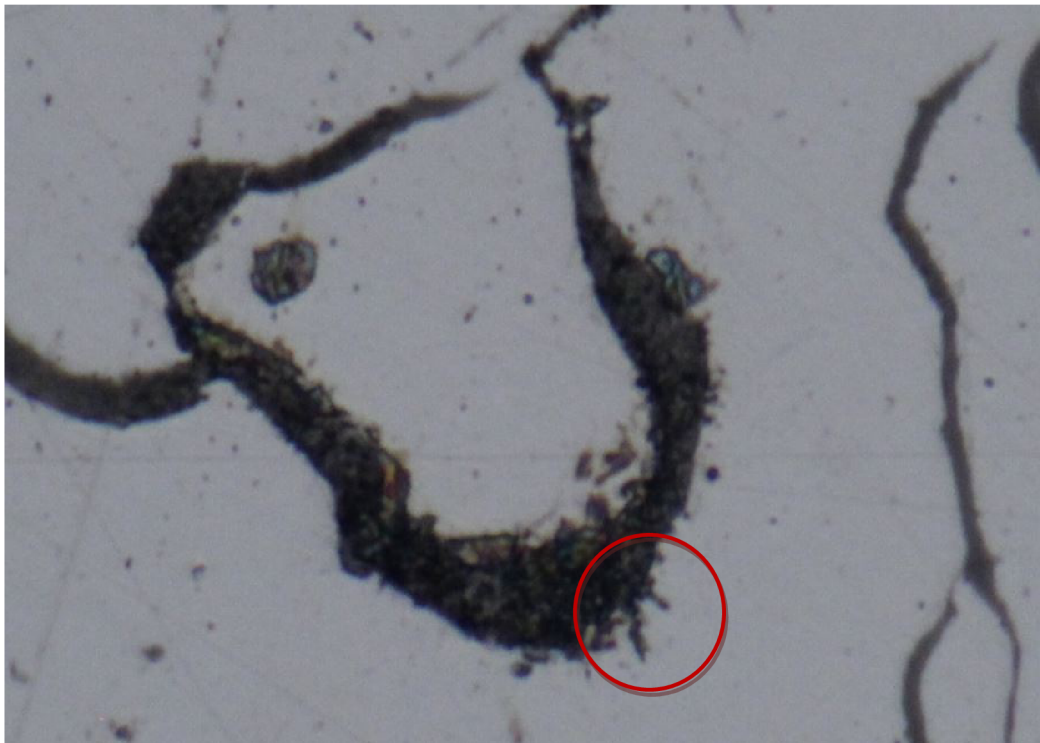
Obr. 36(a) detail: Widmanstättenův grafit na základním lupínku u vzorku s 0,034 hm. % Pb.
