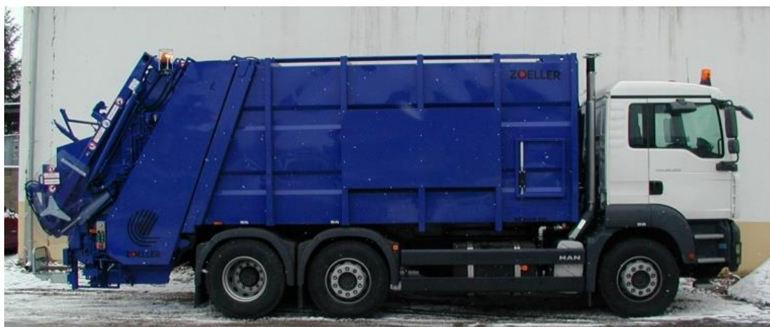
Obrázek 28 Fotografie svozového automobilu MAN 26.320 s nástavbou Zoeller MEDIUM XXL, dostupné z: https://zoeller.cz/man-26-320-medium-xxl-356/
