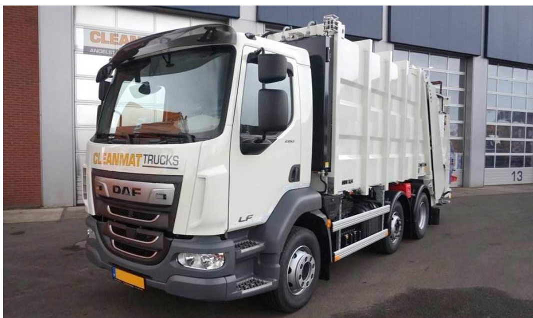
Obrázek 25 Fotografie svozového automobilu DAF LF 260 s nástavbou MINI XL-H, dostupné z: https://www.mascus.cz/preprava/popelarske-vozy/daf-lf260/54gtc56y.html
