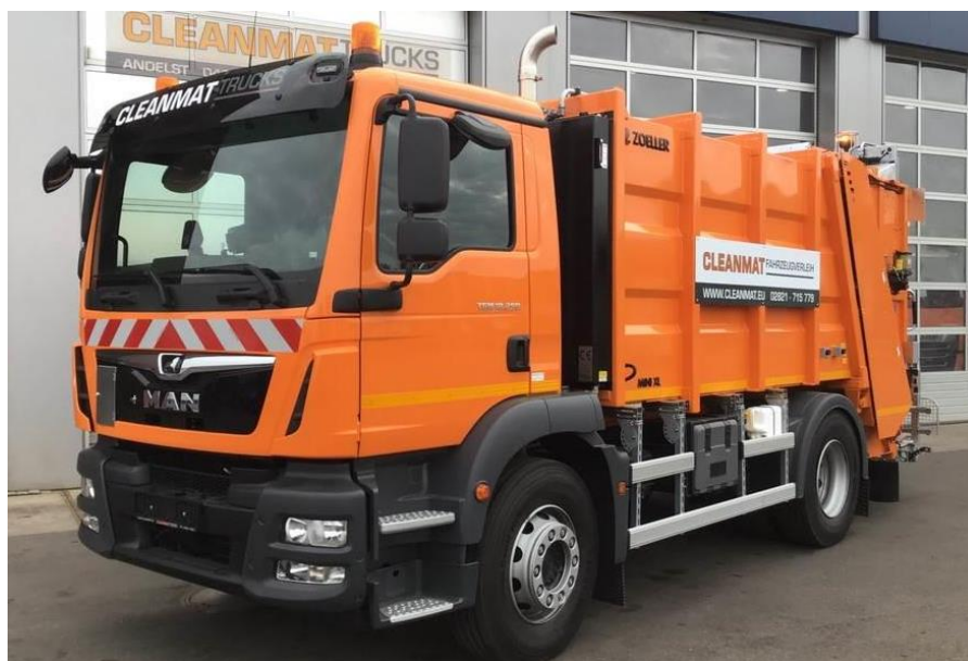
Obrázek 24 Fotografie svozového automobilu MAN TGM s nástavbou MINI XL, dostupné z: https://www.mascus.cz/preprava/popelarske-vozy/man-tgm-18-250-zoeller-11m3/dxiyg14q.html
