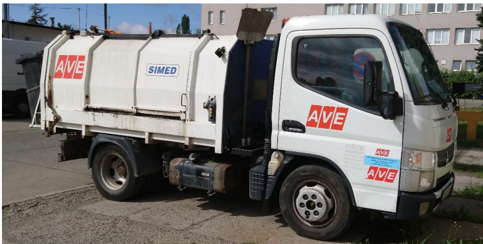
Obrázek 21 Fotografie svozového automobilu Mitsubishi FUSO Canter s nástavbou SIMED LN 4200
