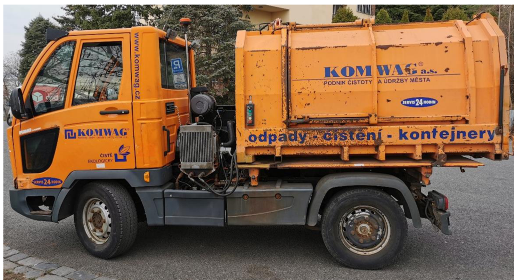
Obrázek 20 Fotografie svozového automobilu Multicar Fumo M30, dostupné z: https://www.veacom.cz/cs/vehicle/detail/36
