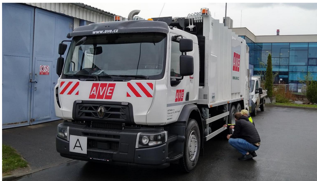
Obrázek 27 Fotografie svozového automobilu Renault D26 380E6 s nástavbou Semat 20 m 3 , dostupné z: https://www.ktech.cz/blog/nove-svoze-vozidlo-pro-ave-kolin
