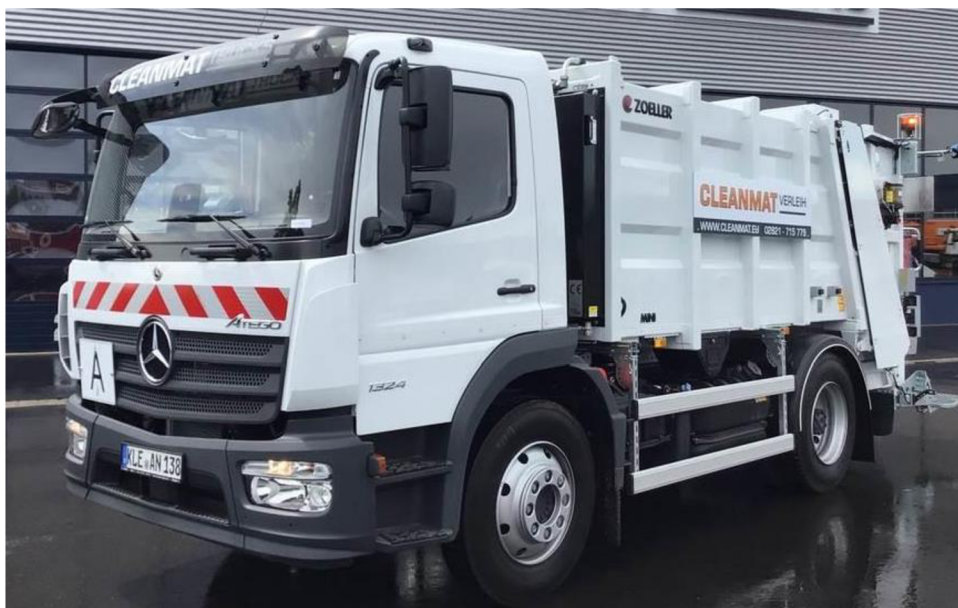
Obrázek 23 Fotografie svozového automobilu Mercedes-Benz s nástavbou Zoeller MINI, dostupné z: https://www.mascus.cz/preprava/popelarske-vozy/mercedes-benz-atego-1324/h4ey954w.html
