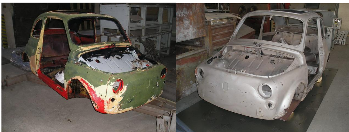
Obr.2 – aplikace otryskávání před a po operaci [8]
