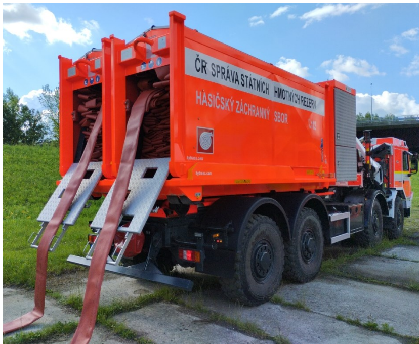
Obrázek 19: rozvíjení vedení pomocí těžké techniky, zdroj: foto autor
