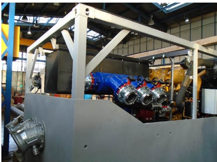
Obrázek 8: sací a výtlačná hrdla MČS 180/330K, zdroj: foto autor
