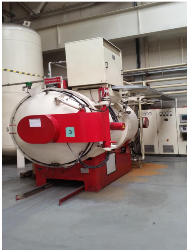
Obr. 6.5: Vakuová pec SCHMETZ použitá při experimentu.
