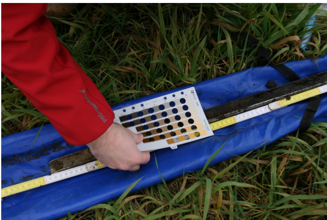
Příloha č. 7: Určování barevnosti půdních vrstev pomocí Munsellovy tabulky.
